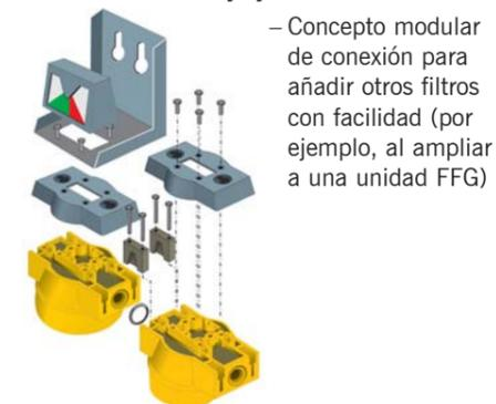
– Concepto modular de conexión para añadir otros filtros con facilidad (por ejemplo, al ampliar a una unidad FFG)
