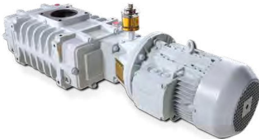
Al producir vacío medio en combinación con una bomba preliminar, la soplante mejora la capacidad de aspiración y la presión negativa de la bomba. El uso de un convertidor de frecuencia reporta ventajas importantes, ya que permite conectar la soplante y la bomba preliminar al mismo tiempo y a presión atmosférica, lo cual acorta notablemente la fase de bombeo.
