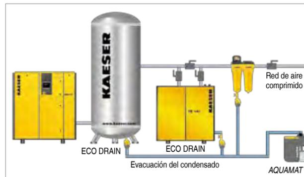
La evacuación segura de los condensados debe quedar garantizada en todos los puntos de acumulación de su sistema de aire comprimido. La mejor forma de conseguirlo es utilizar purgadores de condensados regulados electrónicamente.
