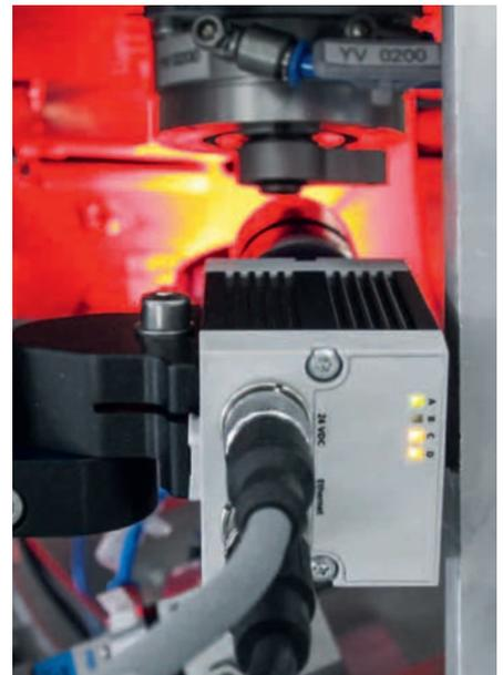
No se descuida ningún detalle: la cámara compacta SBO revisa el contorno de la pieza con una precisión de 50 µm.
