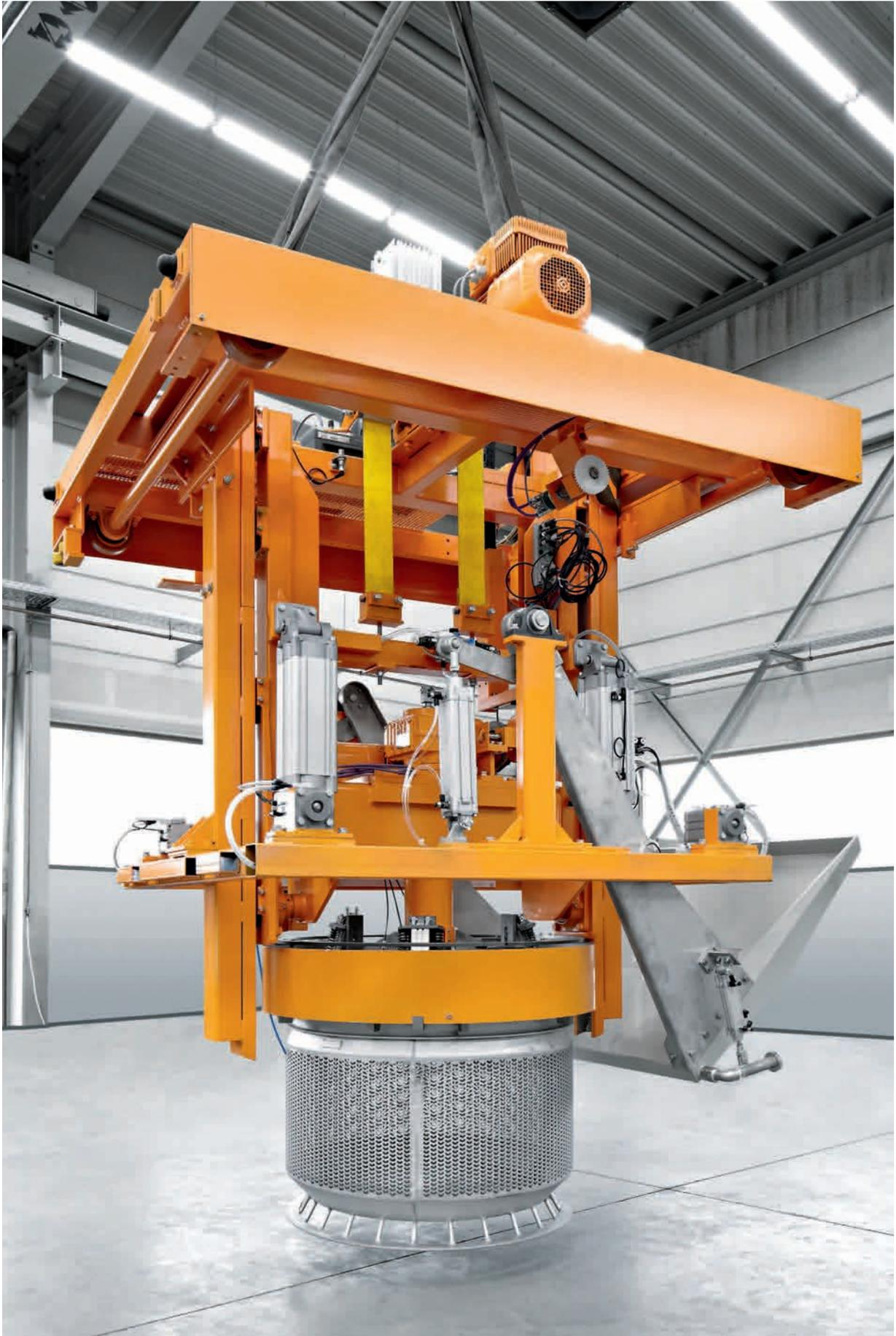
Protección de corrosión máxima que cuida los recursos y ahorra costes: la válvula VFOF-LE-BAH se emplea para el accionamiento neumático de movimientos de giro y de parada en el proceso de tratamiento galvánico del carro de transporte.
