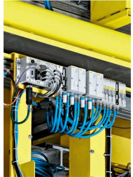
Garantiza la máxima modularidad y flexibilidad: las 24 pinzas se pueden ajustar de forma completamente libre con el terminal de válvula CPX/MPA.
