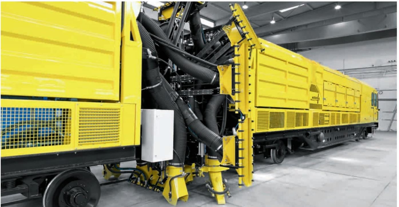
Rápido, seguro y limpio gracias a la servoneumática, el dispositivo de limpieza con sus boquillas y tomas de aspiración móviles, cuenta en cada mitad con tres ventiladores con una capacidad aspiradora de 6 m<sup>3</sup>/s cada uno.
