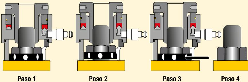
**Paso 1:** El tensionador de pernos se ajusta sobre el espárrago.
