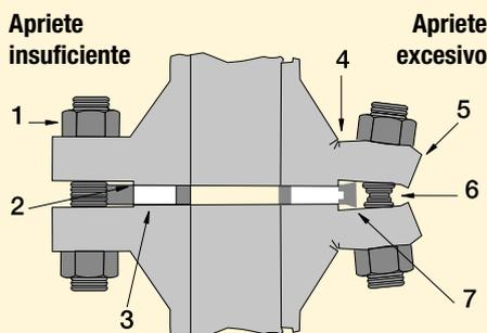
1. El perno se afloja debido a cargas cíclicas de vibraciones.
