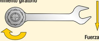
Estiramiento del elemento de sujeción (precarga)
