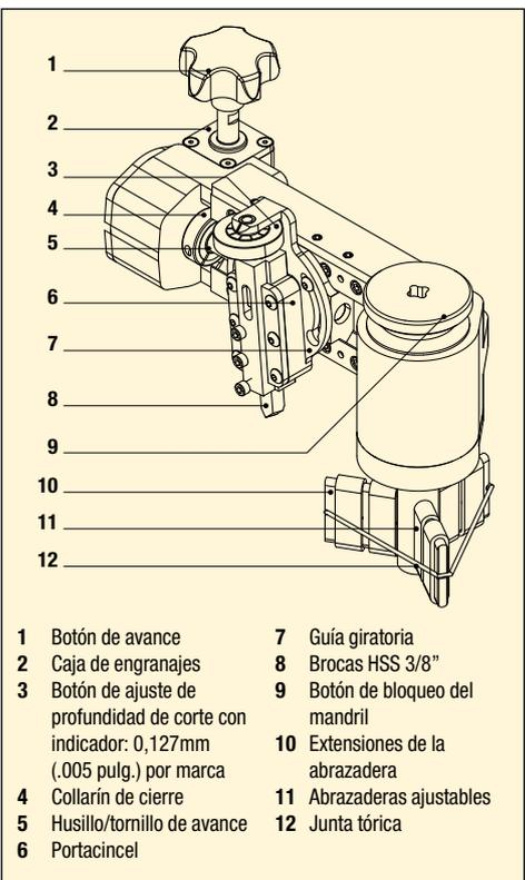
▼ La FF-120 QuickFace ofrece la misma precisión y calidad de acabado que el torno.
