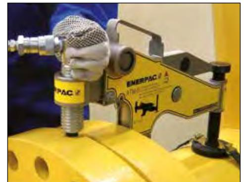
▼ FSC-14, FSM-8 y FSH-14 con los bloques de seguridad SB-1
