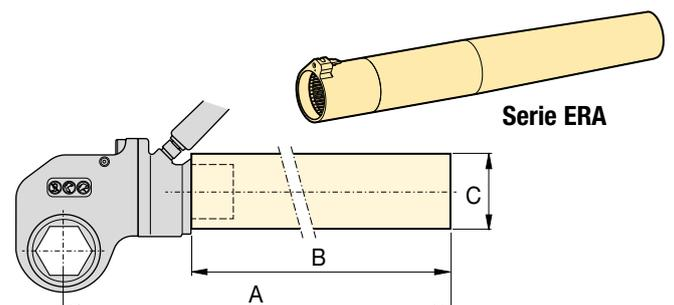
▼ Unidad de accionamiento RSL con cassette hexagonal Slimline intercambiable RLP...SL
