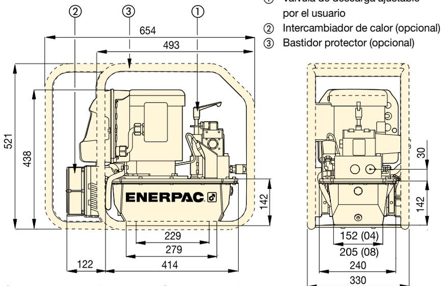
Serie ZE4T y ZE5T con depósitos de 4 y 8 litros
